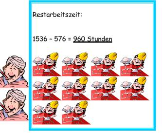
Gesamtarbeitszeit: 12 Arbeiter · 16 Tage · 8 Stunden =  $\frac{1536 \text{ Stunden}}{1536 \text{ Stunden}}$  Arbeitszeit bis 6 Tage: 12 Arbeiter · 6 Tage · 8 Stunden =  $\frac{576 \text{ Stunden}}{1536 - 576}$  =  $\frac{960 \text{ Stunden}}{1536 - 576}$
